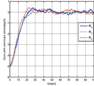
Fig.12. Gyro drift estimation errors
